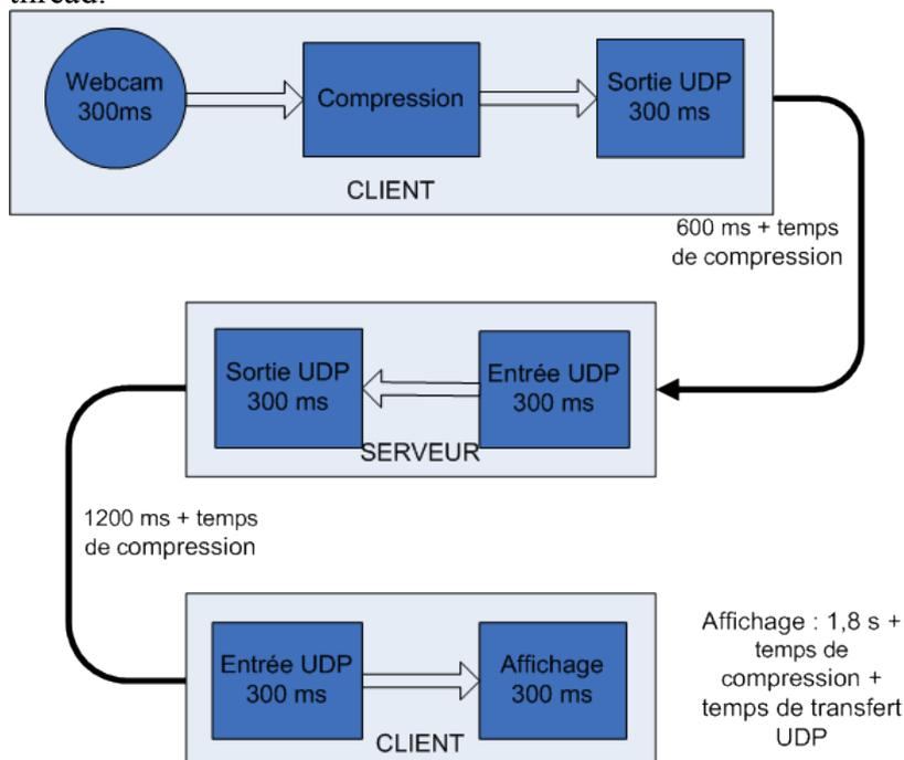
Ce schéma explique les différentes étapes du processus de streaming et l'apparition de latence durant la transmission des flux.
